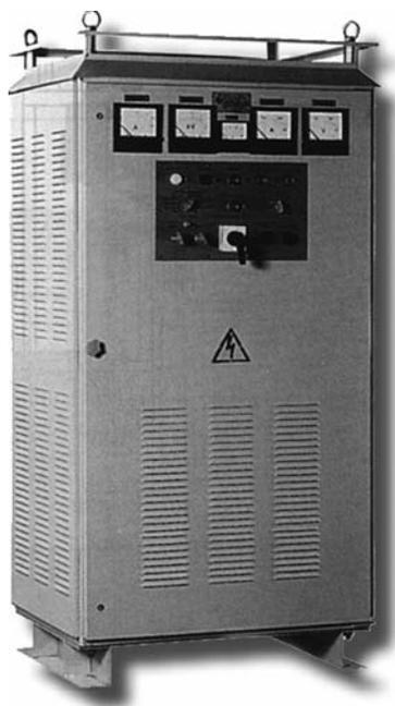
**Возбудители тиристорные типа ВТЕ-200 предназначены для питания обмотки возбуждения и управления током возбуждения при прямом пуске, синхронной работе и аварийных режимах синхронных электродвигателей.**
